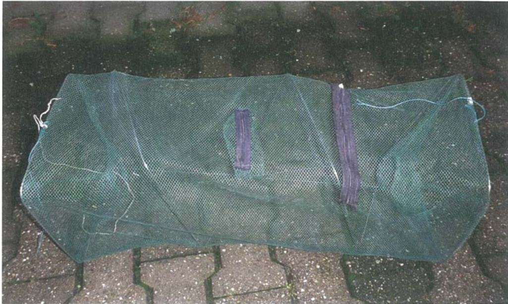
Abbildung 13: Kleinfischreuse (75x28x28 cm) zur Erfassung von Amphibien und deren Larven.
