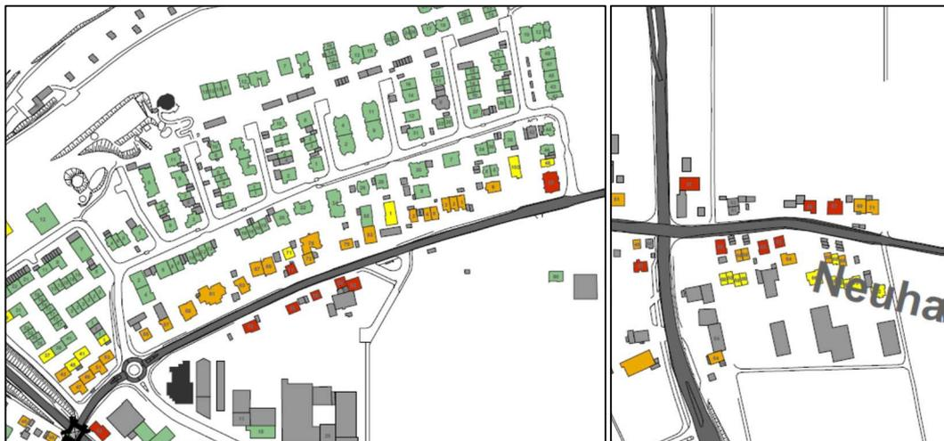
Abb. 21: Auszug Lärmkarte Straßenverkehr nachts 2017 östliche Scharnhäuser Straße (links) und äußere Neuhauser Straße (rechts); Lärmwerte  $\geq 60$  dB (A) in roter Farbe
