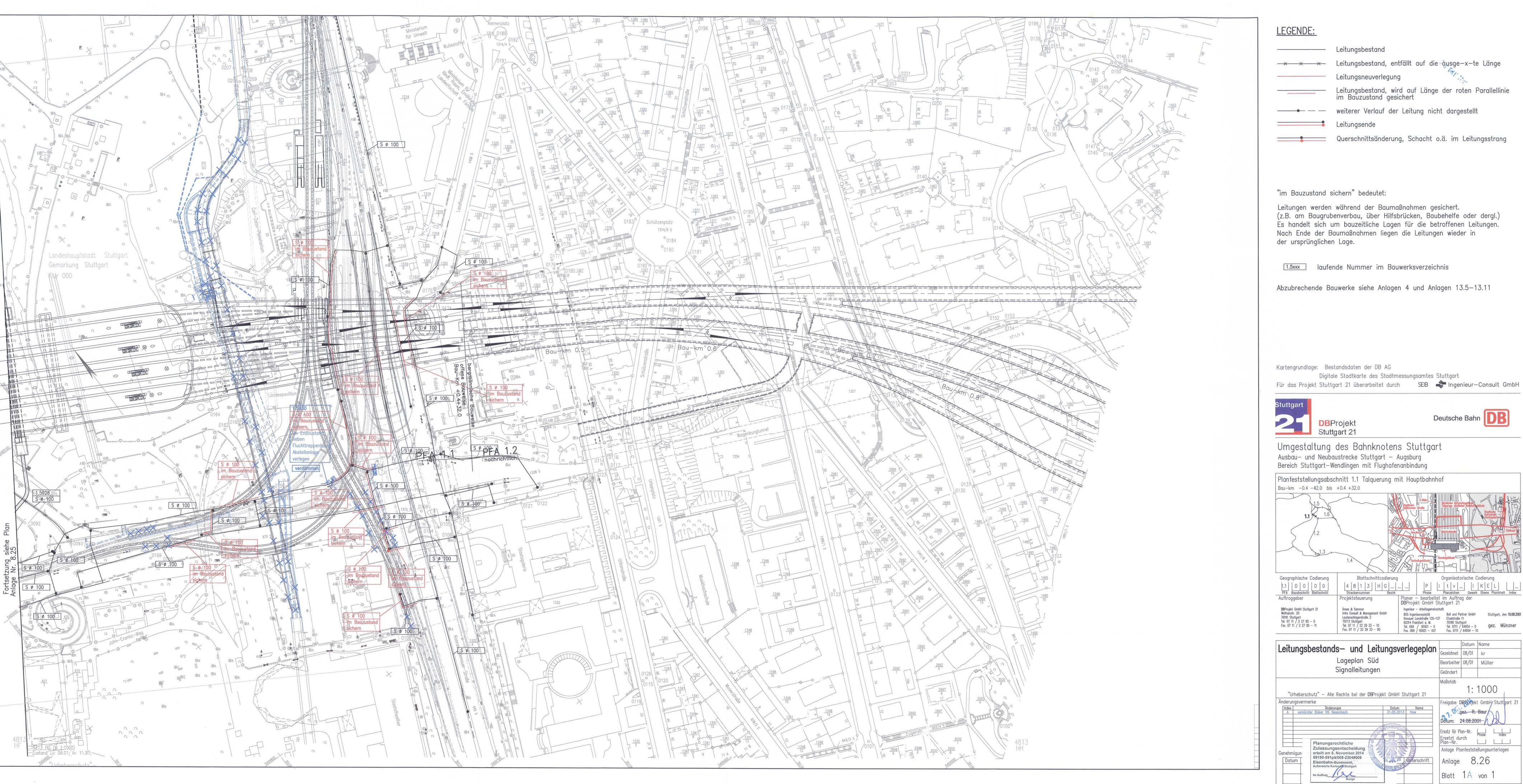
\_\_\_\_\_ Leitungsneuverlegung Leitungsbestand, wird auf Länge der roten Parallellinie im Bauzustand gesichert ----- weiterer Verlauf der Leitung nicht dargestellt \_\_\_\_\_Leitungsende Querschnittsänderung, Schacht o.ä. im Leitungsstrang
