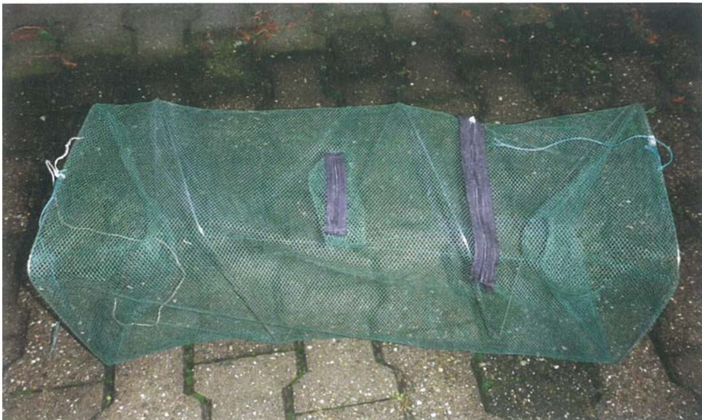
Abbildung 14: Kleinfischreus zur Erfassung von Amphibien und deren Larven (75x28x28 cm).
