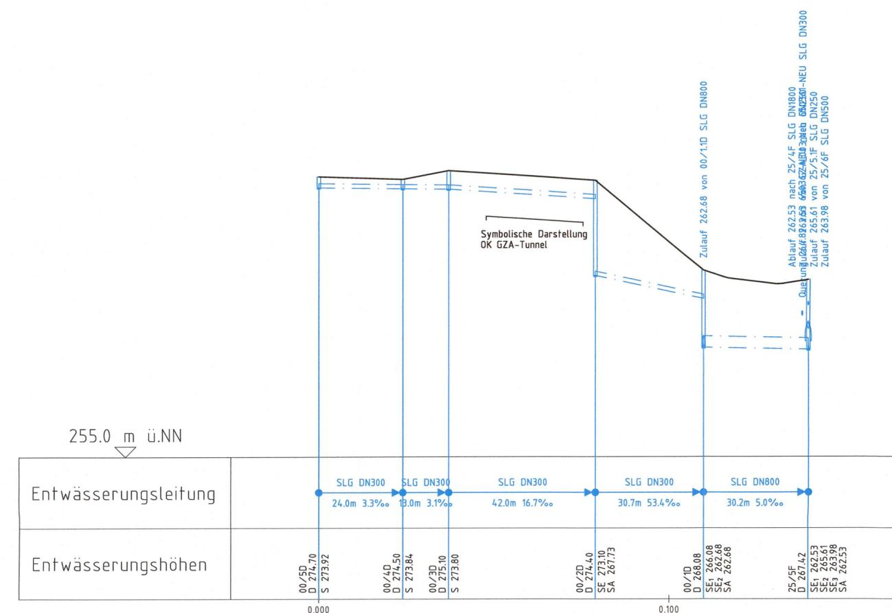
**Längsschnitt Streckenentwässerung 00/5D - 25/5F**
